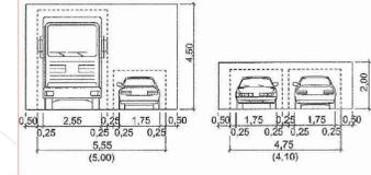
schematisches Beispiel: höhengleicher Ausbau
